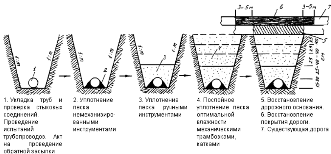
Рис. 2. Последовательность работ по восстановлению дорожной конструкции
