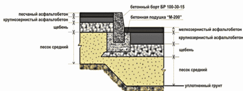
Рис. 3. Схема устройства дорожной одежды внутриквартальной дороги и тротуара
