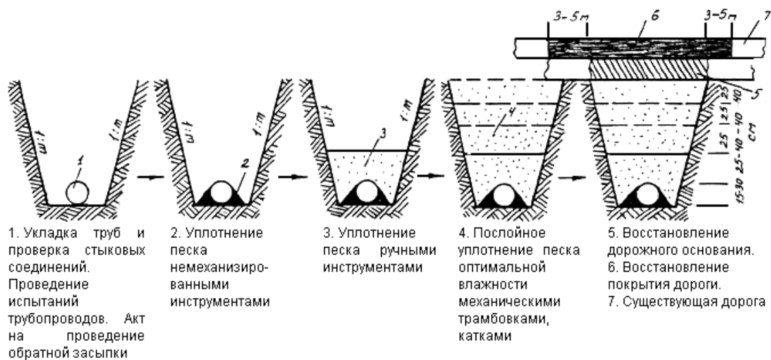
Рис. 2. Последовательность работ по восстановлению дорожной конструкции
